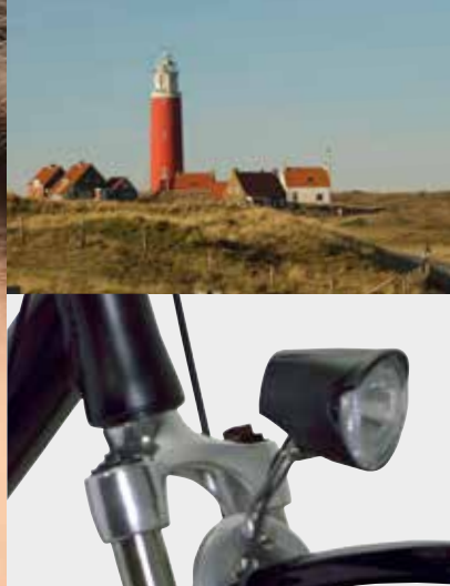
De stijlvolle koplamp van de Primya is voorzien van een naafdynamo
